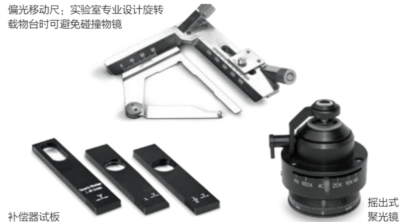
使用高倍物镜观察干涉图像时，摆入锥光镜，从而获得优良效果
